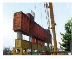
此类构件广泛运用于机场。码头等的装卸 吊运 没有相关标准 而对承载力及挠度 或变形又有一定要求。如图所示为烟台现 代冰轮重工有限公司的锅炉起吊横梁 (3600kN)以及上海永顺丰国际物流有限 公司的马登横梁 (2000kN)。 承载力测试范围。≤10000kN
